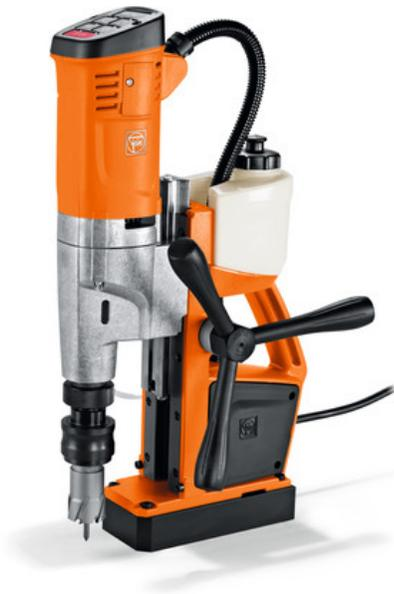
Trapano universale con punta a corona e base magnetica a 1 velocità, dalle dimensioni ridotte e con una corsa molto ampia, con rotazione a sinistra e a destra, attacco portapunta CM2 e la massima funzionalità per lavorare in modo flessibile in cantiere.
