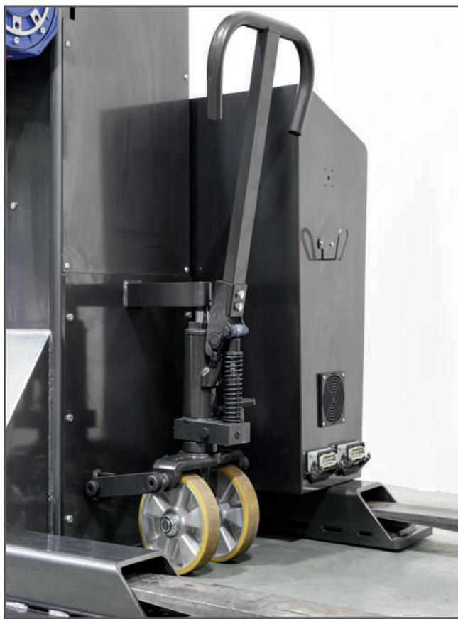
Lo spostamento delle due testate è particolarmente agevolato dal dispositivo di sollevamento manuale, utile anche quando si cambiano i formati dei pezzi movimentati
