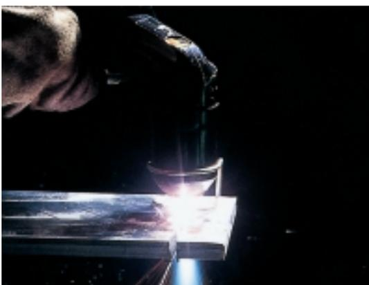
Il taglio al plasma è un processo nel quale un **arco elettrico con utilizzo di aria compressa** è costretto a passare attraverso un ugello, dall'elettrodo al pezzo da lavorare.
