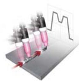
Einstellmöglichkeit eines abgestuften Übergangs min.-max. in der Betriebsart Puls-WIG.
