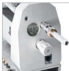
Taglio dell'elettrodo girando la manopola
