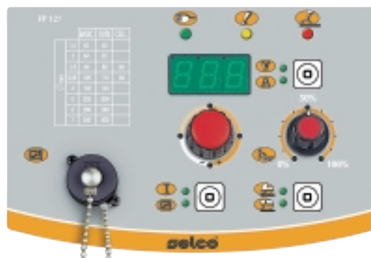
VERSIONE STANDARD: FP127 - Display digitale - Misure di tensione e corrente - Memorizzazione dello stato allo spegnimento - MMA : regolazioni di corrente ed arc-force, funzioni hot-start ed anti-incollamento automatico - TIG : regolazione di corrente.
