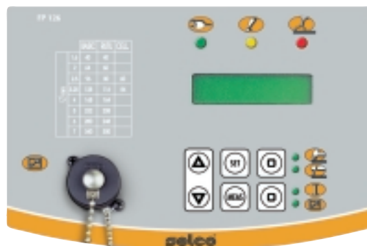
VERSIONE TLE: FP126 - Display alfanumerico - Misure di tensione e corrente - Memorizzazione dello stato allo spegnimento - MMA : regolazioni di corrente, Hot Start ed Arc-Force, funzioni anti-incollamento automatica; valori preimpostati per gli elettrodi più comuni - TIG : regolazione di corrente, con il kit opzionale pulsante torcia: regolazione del tempo di discesa della corrente e del tempo di Post-gas.
