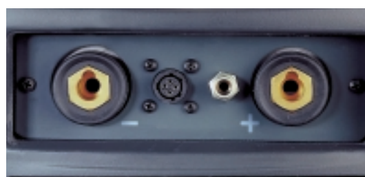
Versione TLE: Si notano la connessione del pulsante torcia e l'attacco per il gas.
