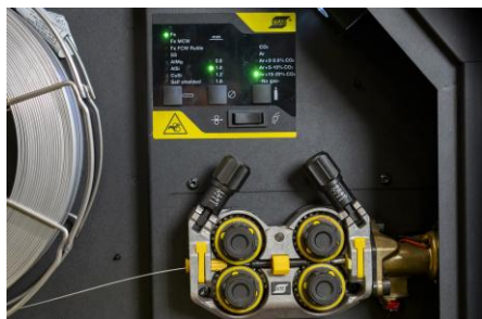
Innovativo meccanismo di trascinamento filo
